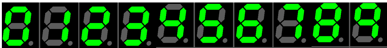
Slika 1. Prikaz znamenki na 7-segmentnom pokazivaču
